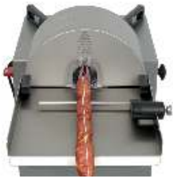
Hilo recto simulando el atado a mano del embutido tradicional. Straight thread tying simulating handmade traditional sausage.
